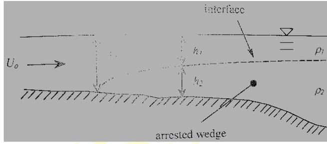
Figure 23. Arrested density wedge [28].
